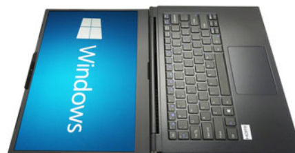
Figura 5 - Panel LCD con apertura de hasta 180 grados con pantalla giratoria
